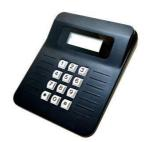
Trasmettitore Chiama Camerieri opera su banda ISM 433 MHz, 8 canali a disposizione Portata in interni: 40 m, Portata in esterni 100 m. Display alfanumerico retroilluminato, montabile anche a muro Configurabile in 4 modalità che genera vibrazioni e/o allarmi acustici differenziati sul pager, oltre alla distinta visualizzazione della chiamata.
